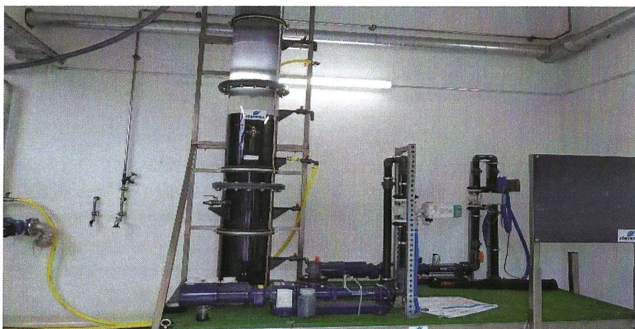
Maquette à l'échelle qui a servi pour les essais, avec le réacteur à gauche, et utilisée aujourd'hui à des fins didactiques
